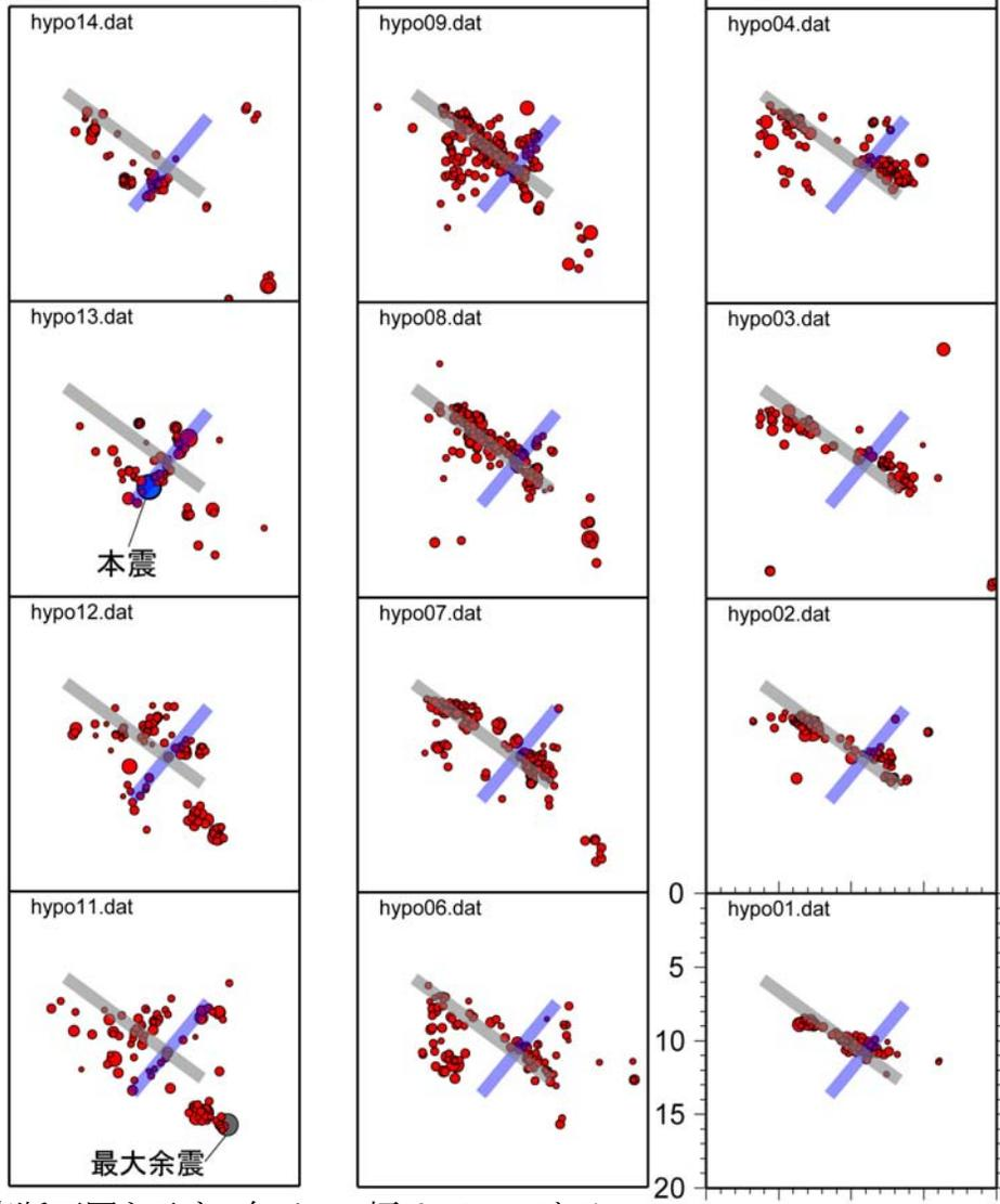
図2. 余震分布の深度断面図を示す. 各ビン幅は、2kmである. 半透明の青線は北西傾斜の断層面、半透明の灰線は南東傾斜の断層面の位置を表す. 半透明の線はそれぞれ対して同じ場所に表示してある.
